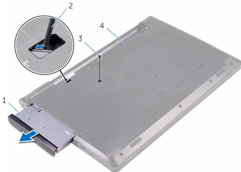
1 sklop optičke disk jedinice
